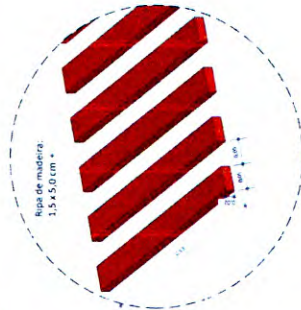
9 DETALHE RIPA DE MADEIRA ESCALA 1:5
