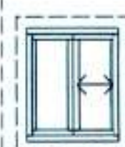
JANELA BOCA DE LOBO
