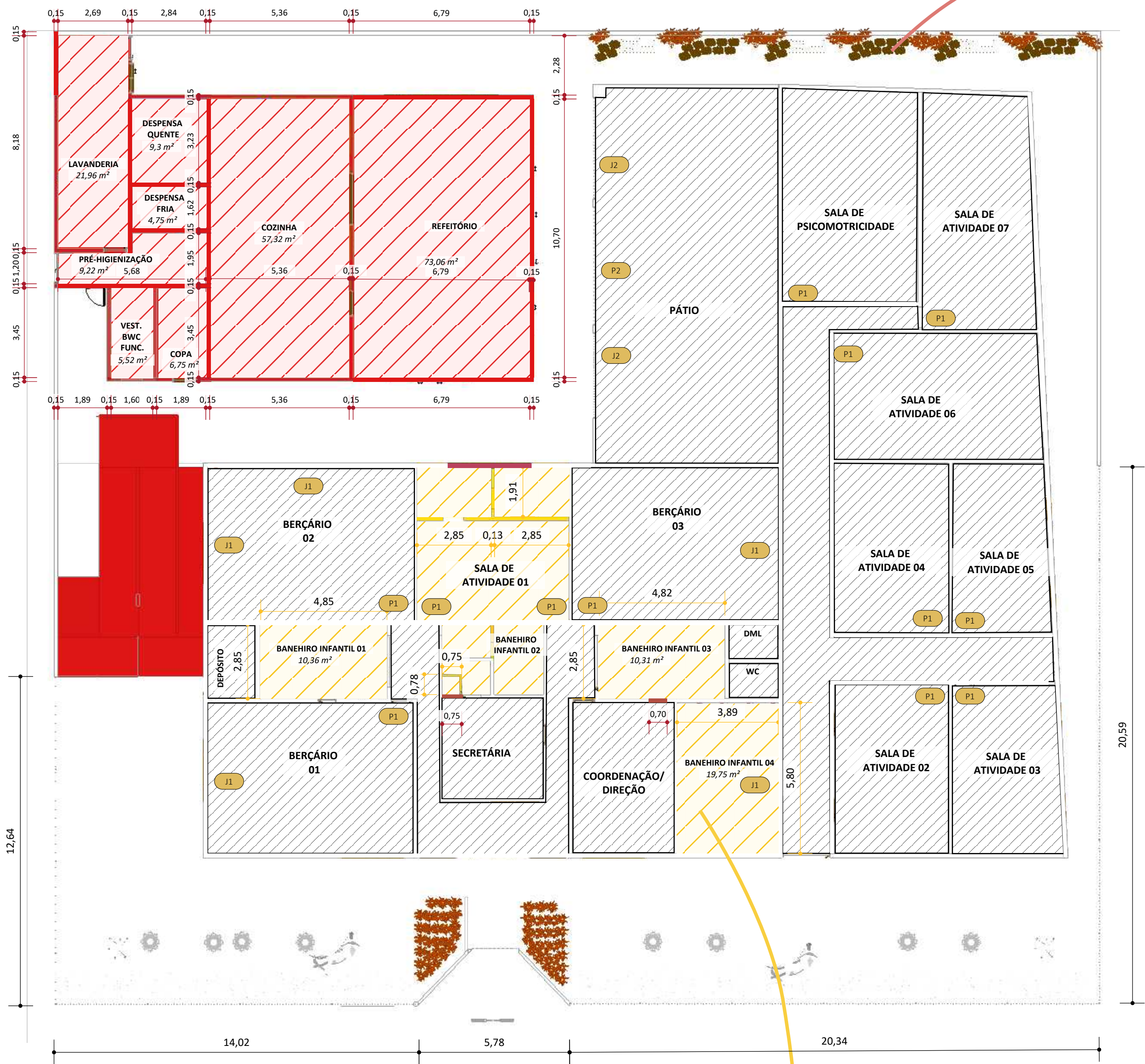
2 PLANTA DE DEMOLIR E CONSTRUIR TERREO
