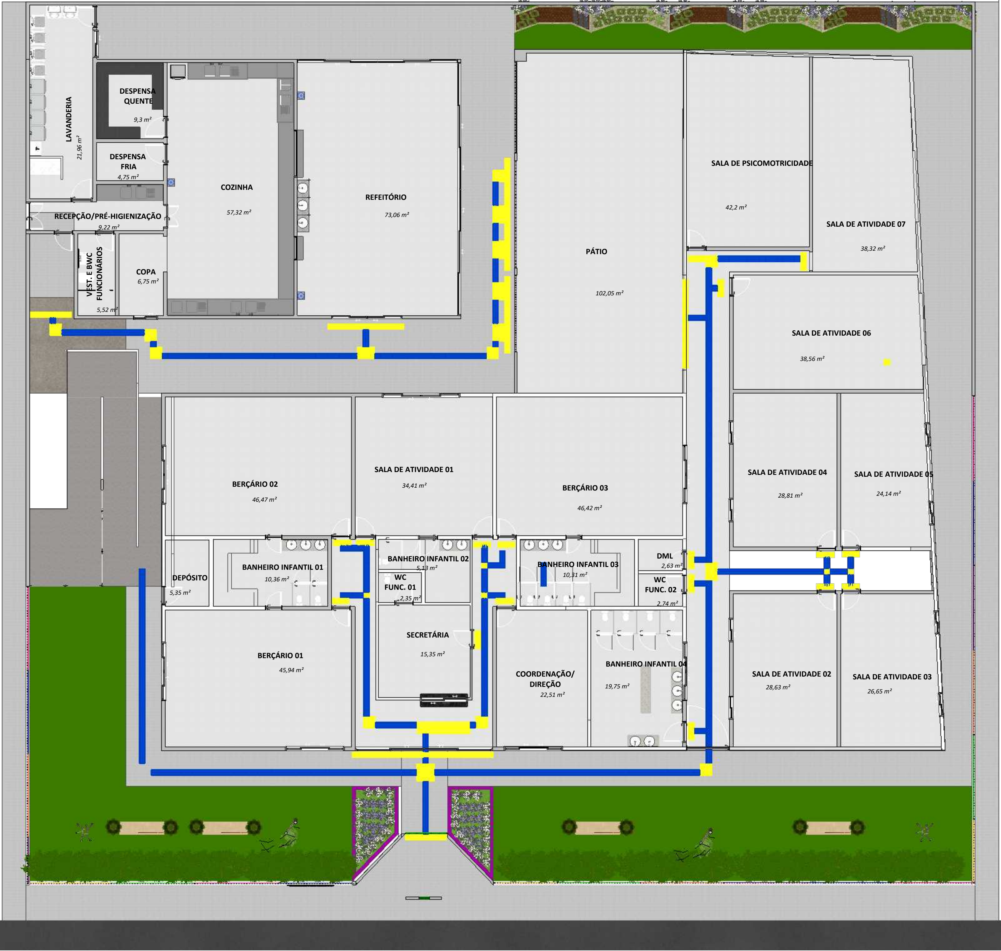
1 PLANTA DE PISO TÁTIL - TERREO ESCALA 1:100
