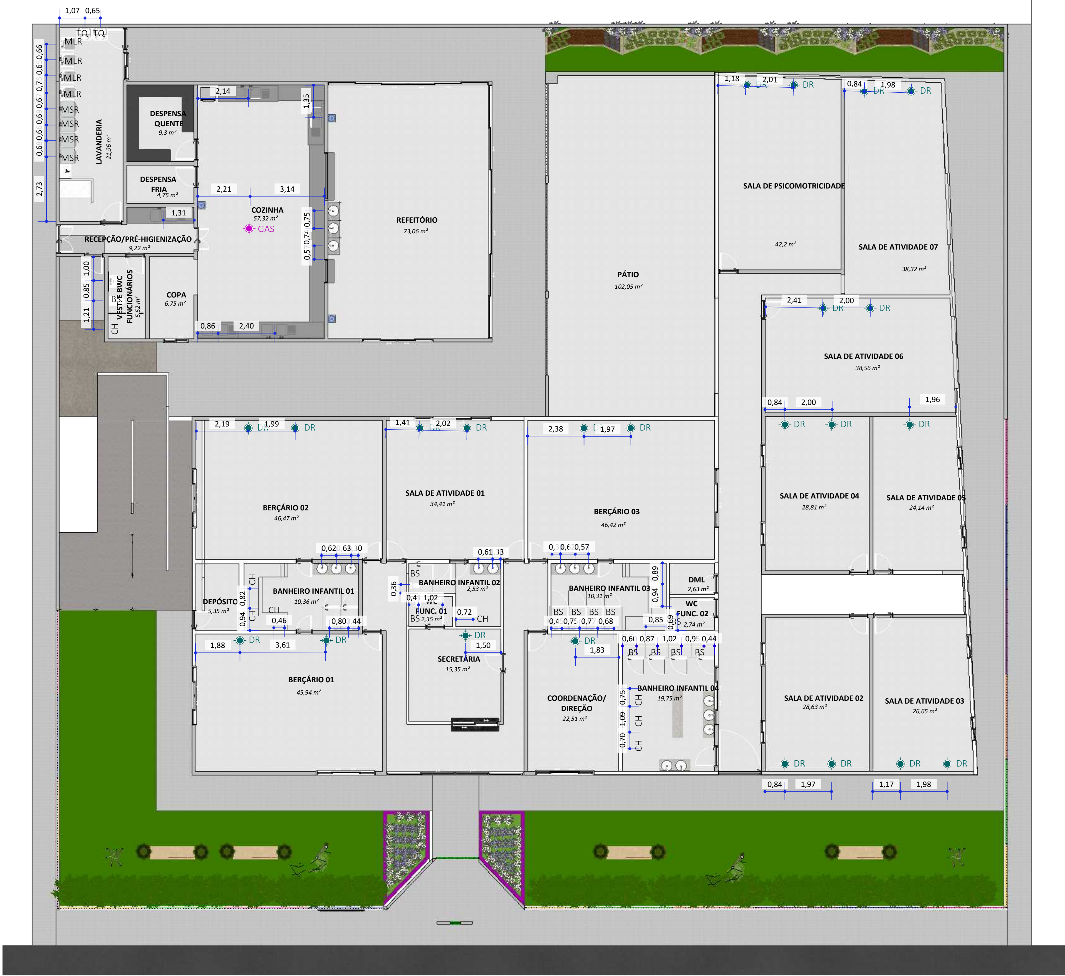
1 PLANTA DE PONTOS HIDRÁULICOS - TERREO ESCALA 1:100
