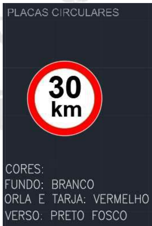
Figura 2. Placa de velocidade, com diâmetro de 60 cm.
