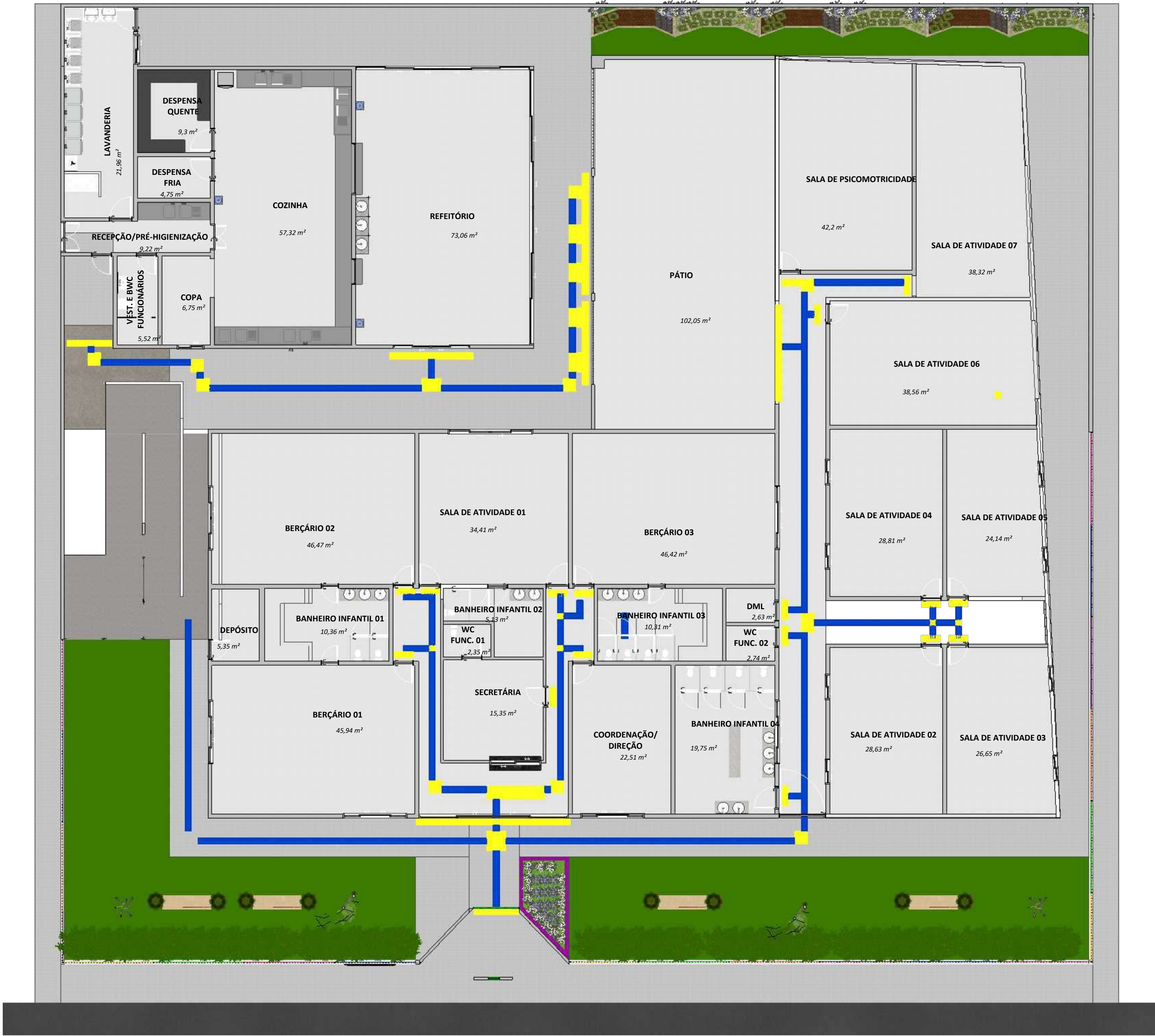
1 PLANTA DE PISO TÁTIL - TERREO ESCALA 1:100
